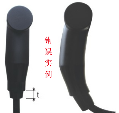
应力锥下移 10 > t > 30 接头装配呈弯型
